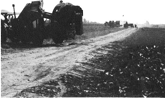
Foto 11: Güllewagen mit Absauganlage
